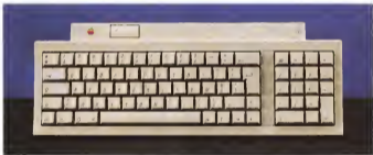
La tastiera fornita in dotazione ricorda quella dell'Apple IIGS: si notano i tasti di reset che in combinazione con altri tasti attivano i «reset programmabili».
